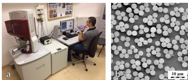
Obr. 4. a) Skenovací elektronový mikroskop MAIA3 od brněnské firmy Tescan používaný ve Fyzikálním ústavu (FZÚ) AV ČR. b) Vnější morfologie magnetických polymerních mikrokuliček z obr. 3b, která byla zobrazena v SEM po depozování kuliček na sklo a pokovení tenkou vrstvou platiny. Mikrofotografie dokazuje kulovitý tvar a značně homogenní distribuci velikostí připravených mikrokuliček 7
